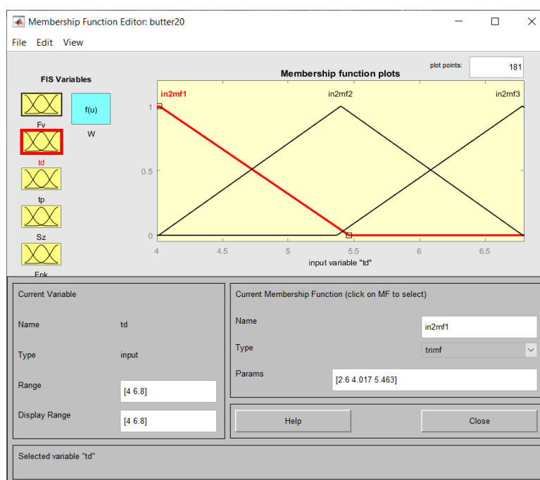
Функції належності для змінної t_d температура дозрівання вершків
