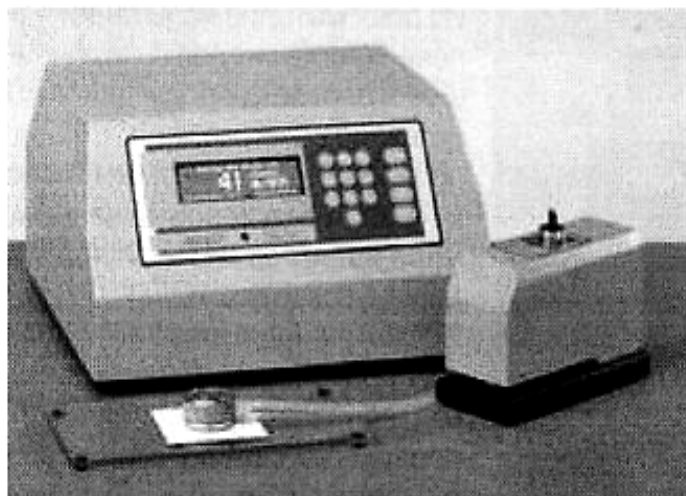
Рис. 2.31. Прилад для визначення поверхневої шорсткості і повітропроникності за Бендтсеном
