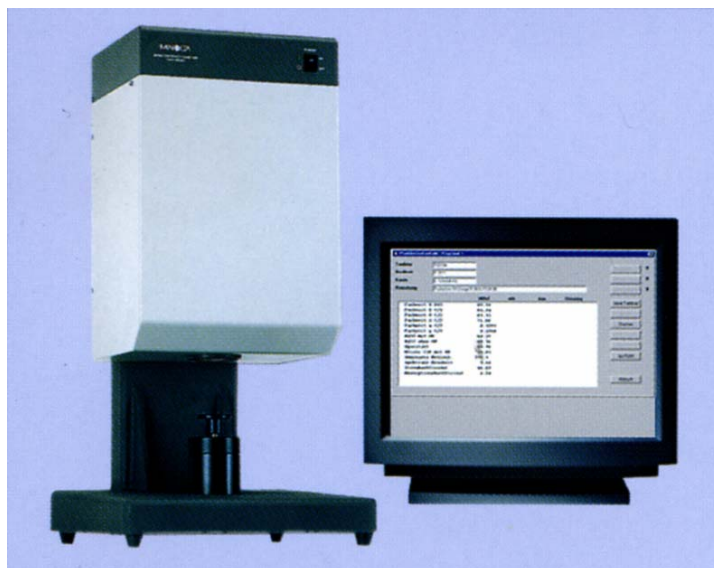
Рис. 2.27. Спектрофотометр з програмним забезпеченням для визначення білості, непрозорості, колірності паперу
